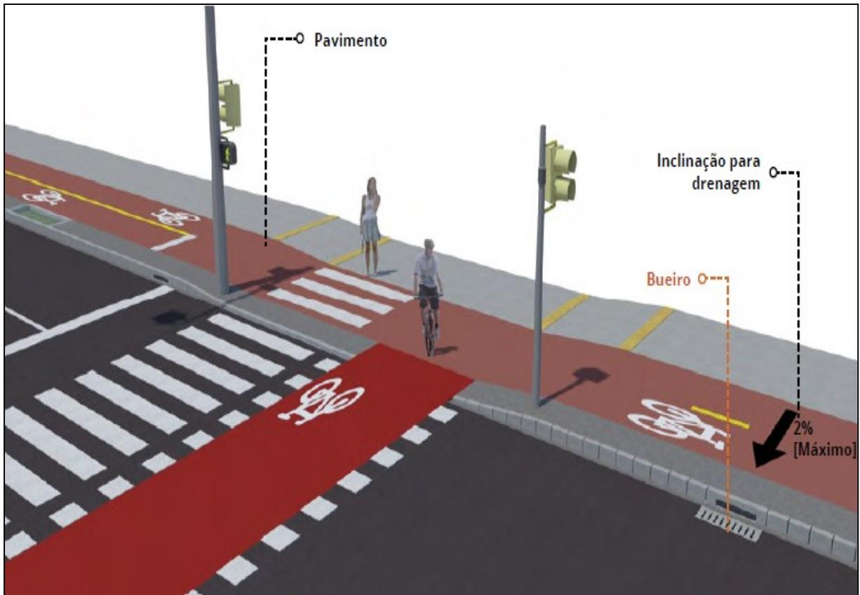
Figura 36 – Pavimento e inclinação para drenagem
