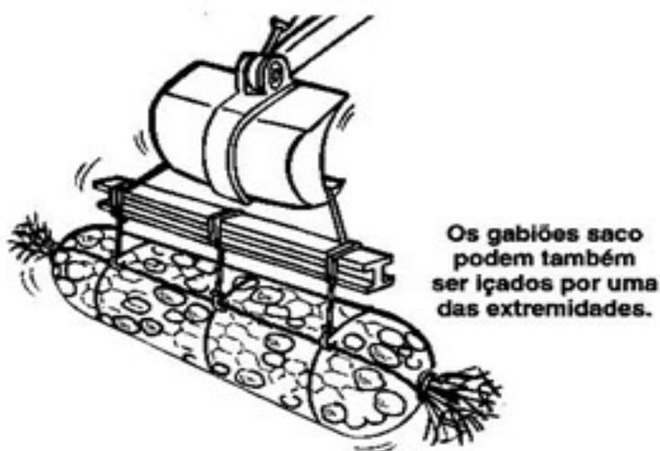
Figura 13 – Posicionamento dos pontos de içamento
