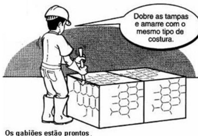
Figura 7 – Detalhe da etapa de fechamento do gabião tipo caixa
