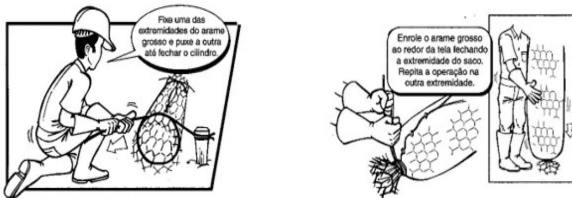
Figura 9 – Amarração e fechamento e detalhe das conformações do gabão saco
