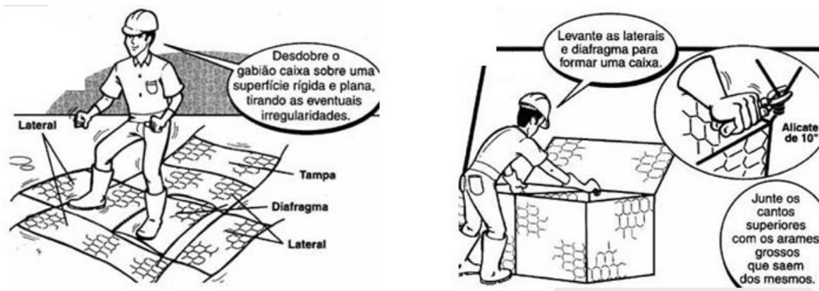
Figura 2 – Preparação para montagem e posicionamento dos painéis laterais
