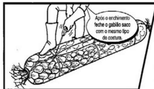
Figura 11 – Enchimento do gabião e fechamento do gabião e fixação dos tirantes do gabião saco
